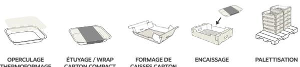
OPERCULAGE THERMOFORMAGE    ÉTUVAGE / WRAP CARTON COMPACT    FORMAGE DE CAISSES CARTON    ENCAISSAGE    PALETTISATION
